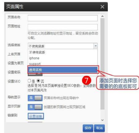
注意：如果模块为底版元素，移动位置需要先解锁。解锁后将失去和底版页面的关联。也就是底板的内容修改后。解锁了的页面将不会变改。
