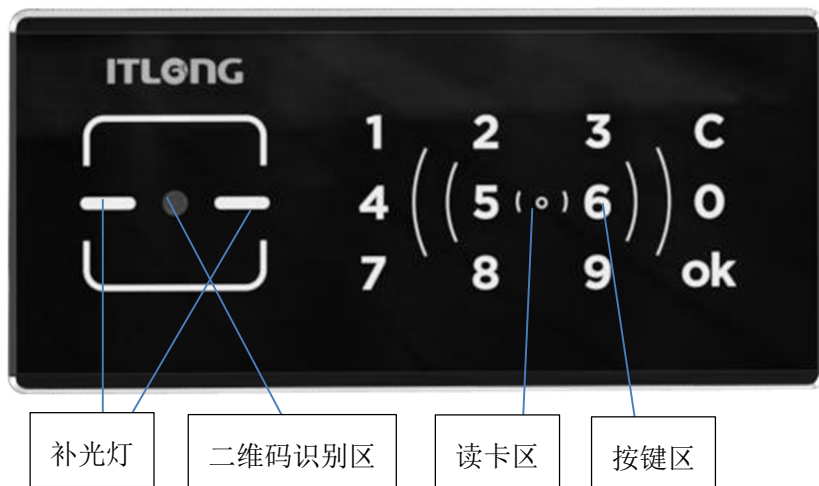
图 1.1 二维码读头示意图
