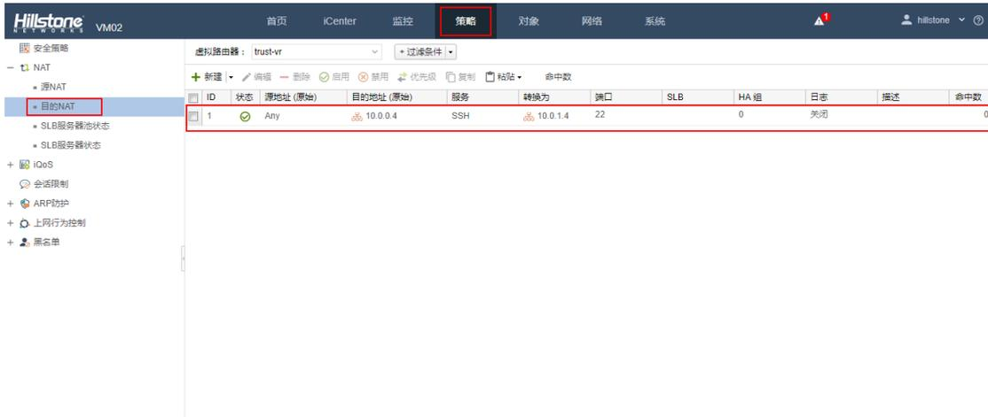
验证 DNAT 策略（在外网通过 SSH 云·界所绑定的弹性 IP 可以连接到环境中的 web 虚拟机）
