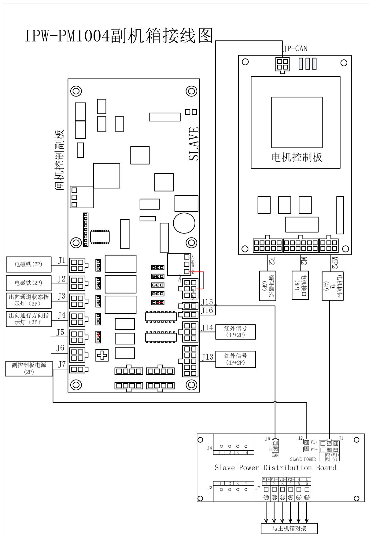
图 B3 闹机副机箱电气接线图
