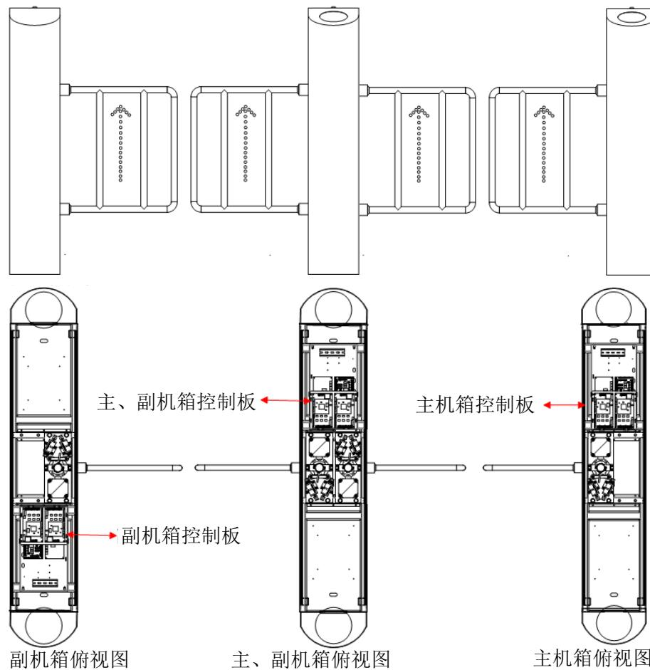
图 B1 闹机主机箱、副机箱电路板安装位置示意图
