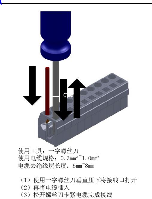
图 B5 闸机控制主板的控制面板常用对外接口的接线说明
