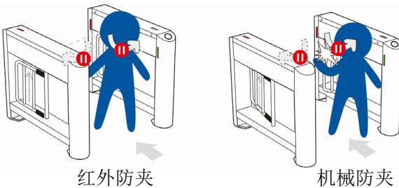
➤ 闸机的机械防夹功能：提供一个合法开门信号，在开门、关门过程中用手挡住门摆，门摆应停止转动。
