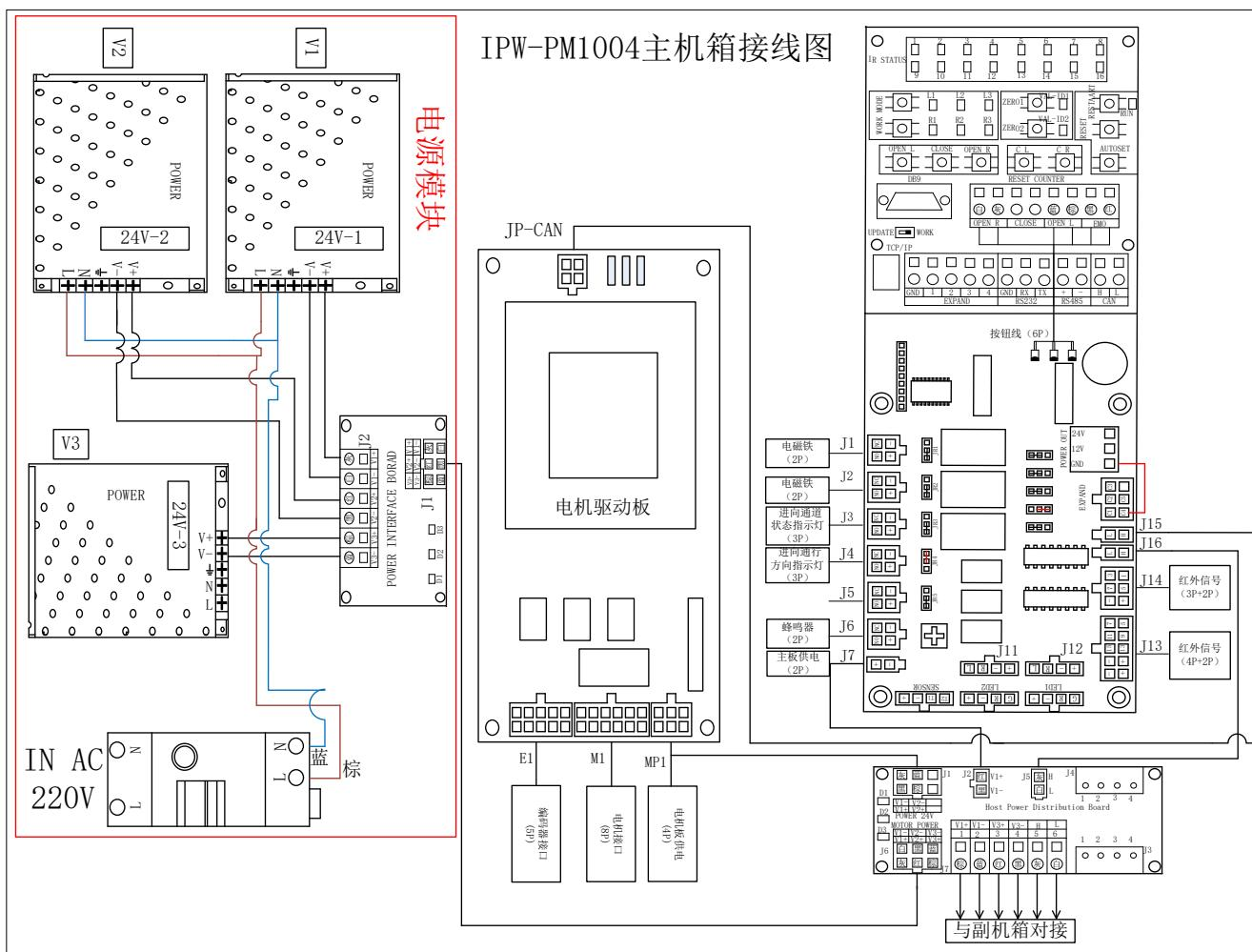
图 B2 闸机主机箱电气接线图
