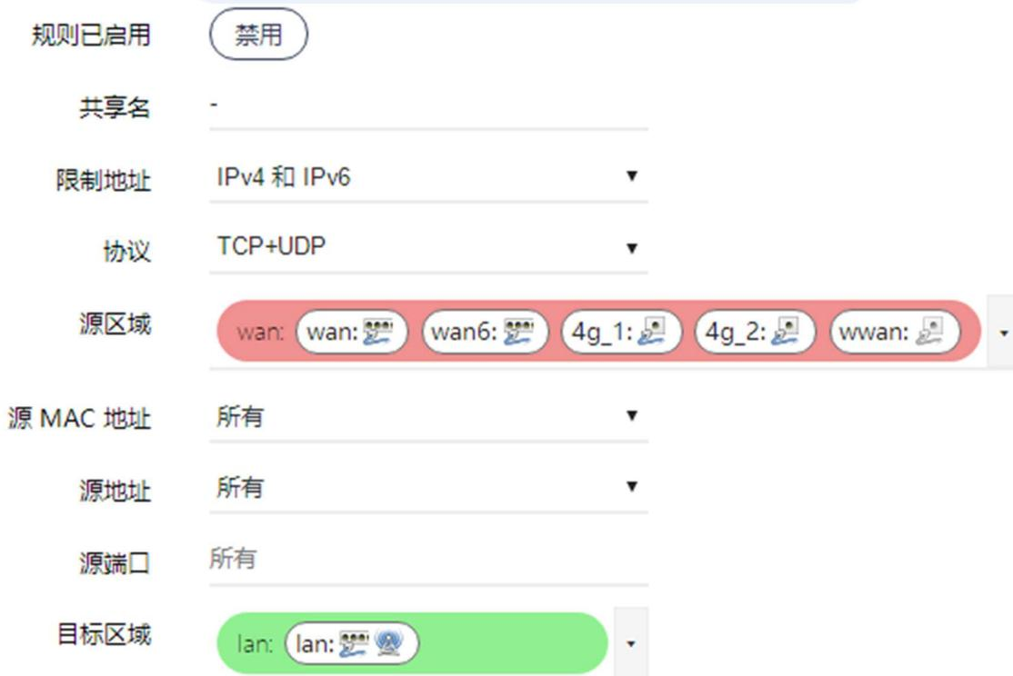
图 15 端口转发设置界面图
